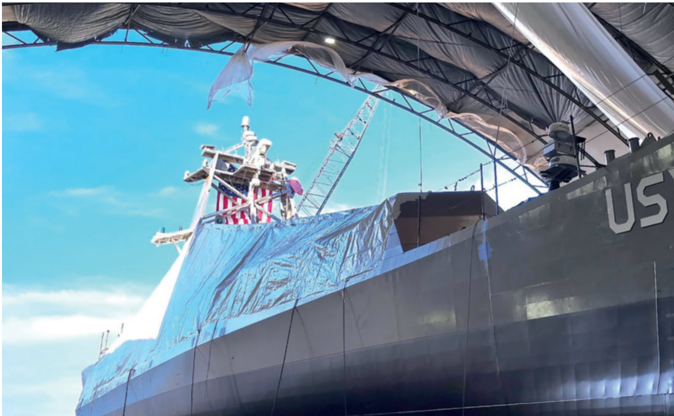
Het US Defense Advanced Research Projects Agency (DARPA) ontvangt binnenkort het eerste USV waarbij in het ontwerp geen rekening is gehouden met een bemanning: de USX-1 Defiant (foto: DARPA)
