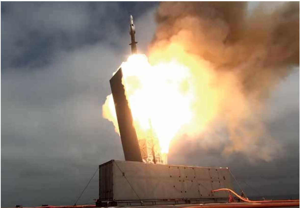
USS Savannah lanceert een SM-6 vanuit een Lockheed Martin Mk 70 containerized missile launcher , 2023 (foto: U.S. Navy Photo)
