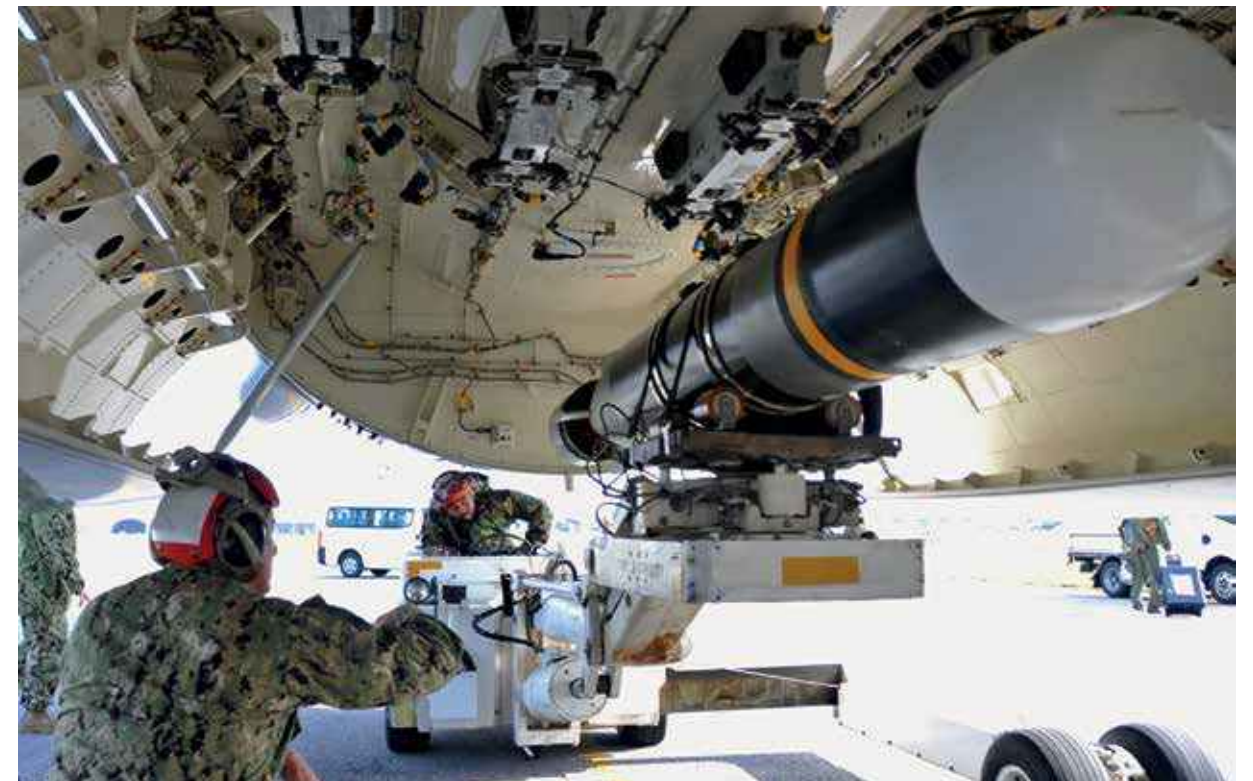
Een Poseidon P8-A wordt uitgerust met een Mark 54 torpedo ter voorbereiding op onderzeebootbestrijdingsoefeningen door de US Navy 7th Fleet in de Indo-Pacific regio, februari 2019 (K.A. Finn, US Navy)
