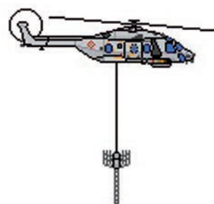
De sensoren van de ASW-eenheden. Links de Low Frequency Active Sonar (LFAS) van een fregat en rechts de Helicopter Long-Range Active Sonar (HELRAS) van een helikopter. (bron: TNO)
