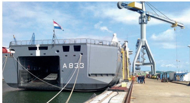
Vanaf de achterzijde vallen de stern quarter ramp (rechts, gesloten) en de beach (links, open) direct op. Deze twee zijn essentieel voor belangrijke capaciteiten van het schip: strategisch zeetransport en sea-basing. (Foto: collectie auteur)
