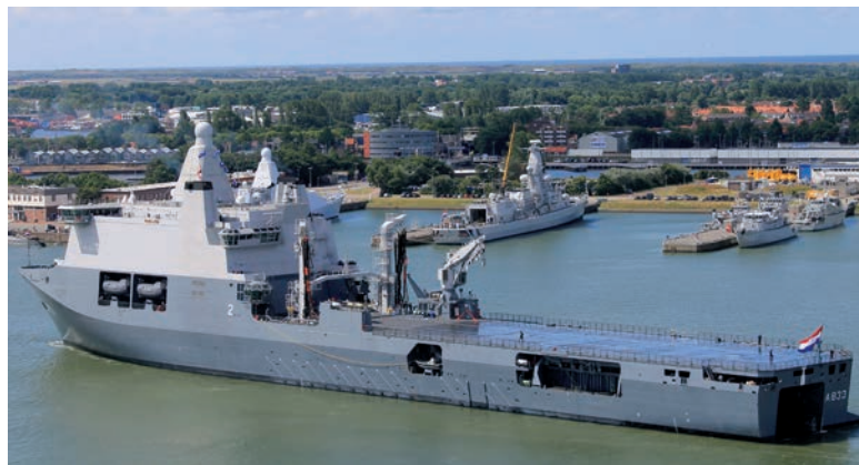
Bij het zien van de Karel Doorman langszij zijn de hoofdtaken goed te zien: midscheeps de masten voor bevoorrading en kranen en achteraan het grote helikopterdek. (Foto: collectie auteur)
